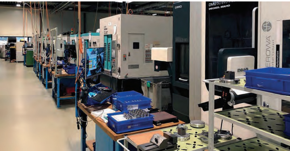
Gearbeitet wird bei der Pavese AG tagsüber im Einschichtbetrieb und in der Nacht oder übers Wochenende im Geisterbetrieb, das heisst automatisiert mit Robotern. (Bild: Pavese)
